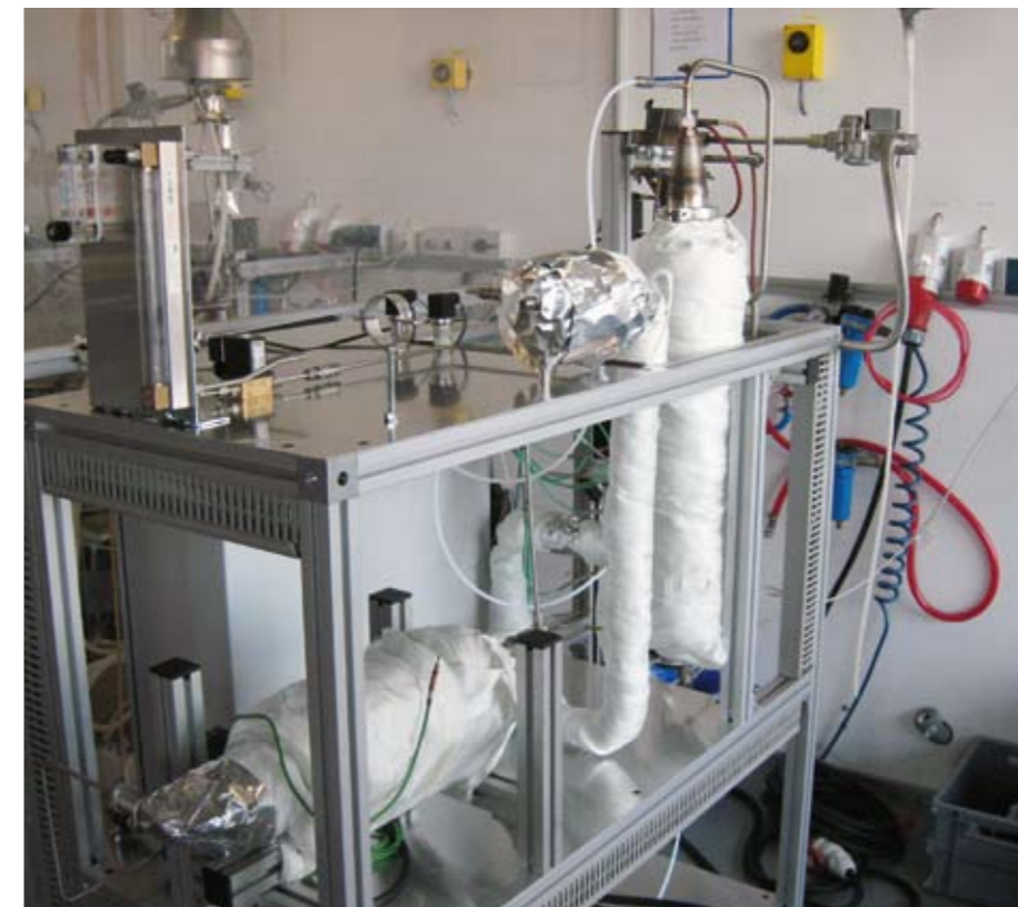
Reformer: Macht PKW-Diesel für die Brennstoffzelle nutzbar
