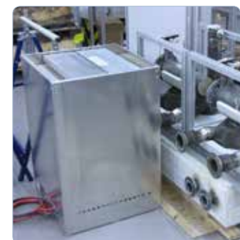
Teil des SOFC Laboraufbaus mit einem der beiden 5 kW Module
