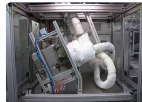
Test eines SOFC Moduls auf maritime Tauglichkeit (Neigung, Vibration)
