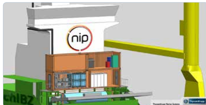
CAD-Darstellung des Demonstratoraufbaus mit einem hybridisierten 100 kW SOFC-System auf der MS Forester
